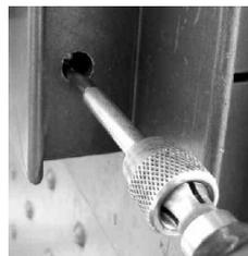
Heureusement, on s'en sort avec un simple tournevis plat, avec une lame de 5mm de large et 1mm d'épaisseur (probablement dans les 5,5mm de large si la lame du tournevis est plus pointue que cela).
